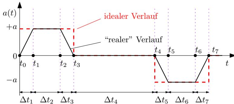
Ziel dieses Versuches ist die Berechnung der Kurve  $s(t)$  über die Integration von  $a(t)$ , um z.B. die mittlere Stockwerkshöhe zu berechnen. Die mittlere Beschleunigungen bzw. Geschwindigkeiten und Strecken in den jeweiligen Zeitintervallen  $\Delta t_n = t_n - t_{n-1}$  mit  $n = 1, 2, \dots, 7$  sind nach [Fromme]:
