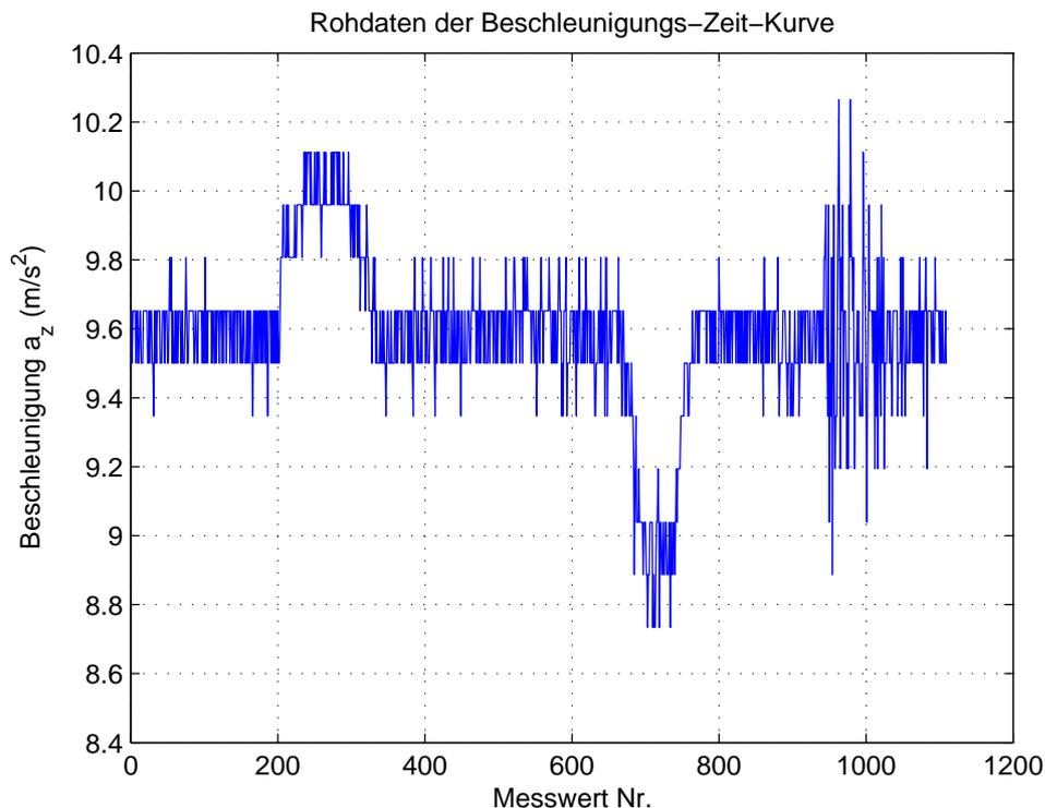
Wie man im obigen Diagramm sieht, sind die Rohdaten in dieser form nicht auswertbar. Man sieht lauter "Stufen", die aufgrund der Diskretisierung entstehen und einige Spitzen, die durch Wackler bzw. Störungen verursacht wurden. Ausserdem haben wir einen Offset von ca.  $9.6m/s^2$  gegenüber dem Nullpunkt.
