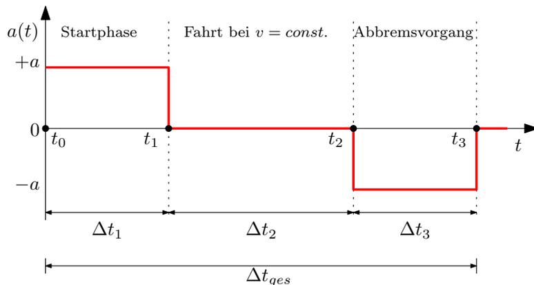
Die Fahrt mit dem Fahrstuhl wurde mehrmals von der untersten bis in die oberste Etage durchgeführt, also von 1. OG  $\rightarrow$  2. UG. Es wurden effektiv  $N = 3$  Etagen durchfahren wobei es sich bei der scheinbaren 4. Etage (Ausgang  $\rightarrow$  2. UG) um eine Rampe für Rollstuhlfahrer handelt. Deren Höhe beträgt etwa  $(22 \pm 3) \text{ cm}$ , d.h. die durchfahrene Gesamtstrecke beträgt nach Messung mit einem Meterband  $s_{ges} = (1010 \pm 4) \text{ cm}$ .
