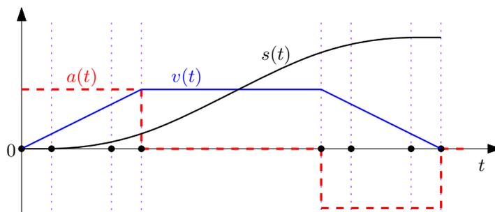
Abbildung 1: Qualitativer Verlauf der Beschleunigung, Geschwindigkeit und der Strecke in Abhängigkeit der Zeit
