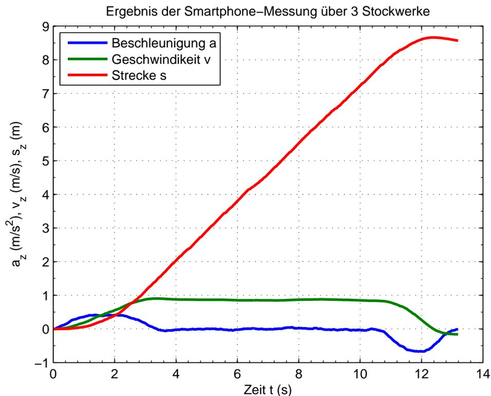
Das Ergebnis der Smartphone-Messung lässt sich sehen. Aufgrund der Zeitmessung im Millisekundenbereich lassen sich die Zeitintervalle genauer konstruieren und die zurückgelegte Strecke von  $s_{ges} = 8.6m$  weicht nur um 15% vom genau bestimmten Wert von  $h = 10.1m$  ab. Allerdings sind die Messunsicherheiten dieser Messung unbekannt
