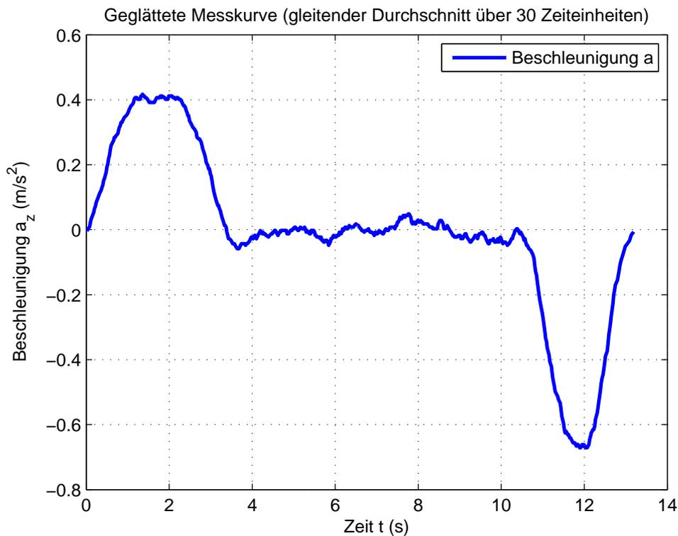
Anhand der geglätteten Messkurve kann man nun numerisch Integrieren gemäß der Trapezregel. Die hierfür benötigte MATLAB-Funktion heisst `cumtrapz()`. Der Vorfaktor von 0.0224 entspricht der mittleren Zeitdifferenz zwischen den Messwerten. Leider speichert das Handy nicht alle Messwerte in gleichmäßigen
