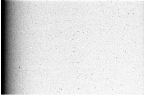
(a) Ein Master-Dark-Frame aus 20 Einzelaufnahmen. Im linken Teil des Bildes ist Bildrauschen sichtbar, verursacht durch Bias. Das Bias zeigt das elektronische Rauschen (read out noise) der Kamera.
